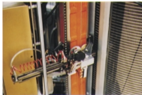
Fig. 7. RAMAC Actuator (Courtesy IBM.)
